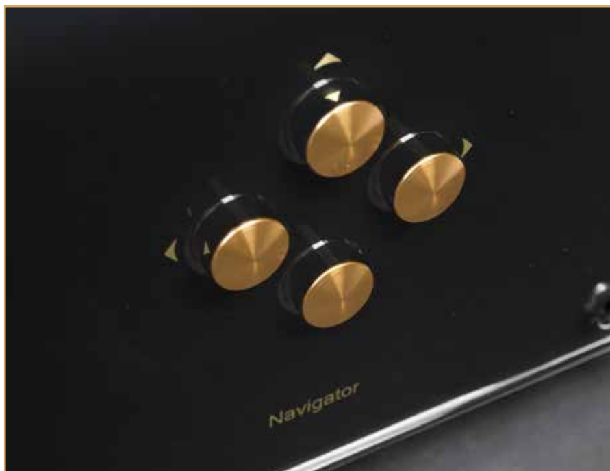
Interessant ist die Lautstärkeregelung am Frontpanel per Knopfdruck. Auch bei Vorgänger-Modellen entschied man sich gegen einen Drehregler
