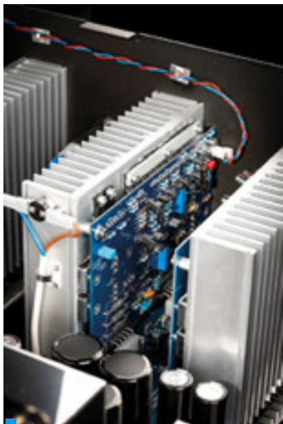
W torze wzmocnienia napięciowego dominują tranzystory, ale są też pojedyncze wzmacniacze operacyjne (OPA 2134UA).
