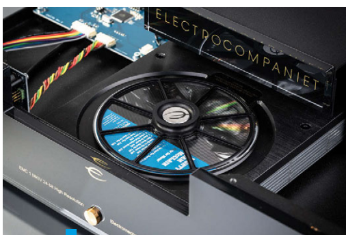
Opcjonalny Spider trzyma płytę po całym obwodzie i ma znacznie większy moment bezwładności niż standardowy docisk.
